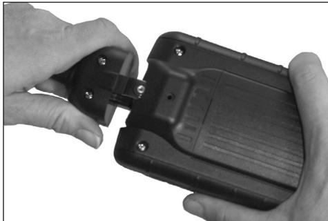
4. Para fixar um novo cabo, alinhe o cabo e os recipientes do analisador e una-os. Insira o parafuso e aperte-o.
